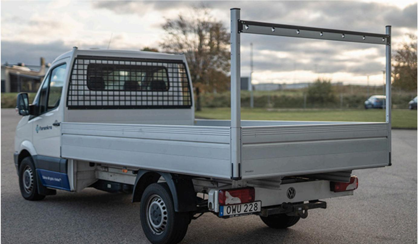
Armaton MP LongGoods gör transport av långgods säkert och tryggt. Det monteras enkelt i bakre stolpar och framstam, vilket ger en komplett lösning.
