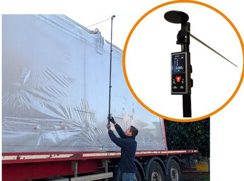
5) **Fonction MEASURING-STICK** : permet de mesurer la hauteur d'un véhicule ou d'une charge depuis le sol. Le laser du télémètre prend repère au sol jusqu'en haut de la cible noir. Les mesures s'affichent sur l'écran.
