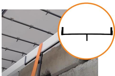
3) **Fonction CORNER-STICK** : permet de poser et déposer facilement les cornières de protection de 1m20 à 2m40 de longueur. Équipée d'un **revêtement anti-glisement** sur les pinces, les coins et cornières sont mis en place en toute sécurité.
