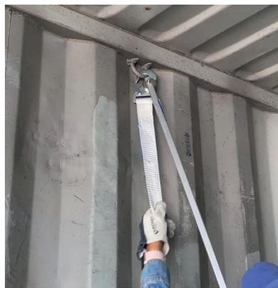
4) Tout en maintenant la sangle tendue parallèlement au manche de la baguette, déposer le mousqueton sur l'anneau d'ancrage. Une fois en place, tirer sur le manche de la baguette.
