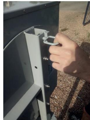
Si la barrière est très tendue, il est conseillé de défaire la tension au niveau du poteau d'arrimage en premier lieu. Allez ensuite derrière la boîte à enrouleur et tirez sur la bague de blocage et faites-la tourner de 90 degrés pour qu'elle reste en place.
