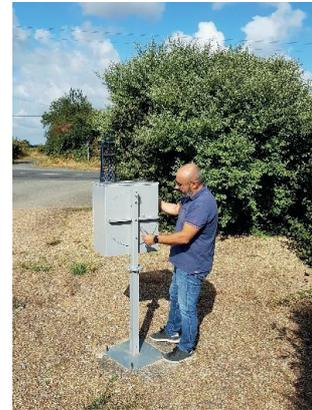
Enlevez le cas échéant le cadenas verrouillant l'orientation de la boîte. Desserrez légèrement les boulons maintenant la partie supérieure du poteau sur la partie inférieure. Faites tourner la boîte jusqu'à l'angle souhaité. Vous pouvez maintenant déployer la barrière pour l'inspecter, sans bloquer la voie, ce qui est utile pour des axes très fréquentés.
