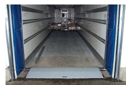
Plaque de liaison pour un chargement en sécurité.
