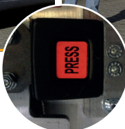
Loquet de blocage de la rampe en position repliée
