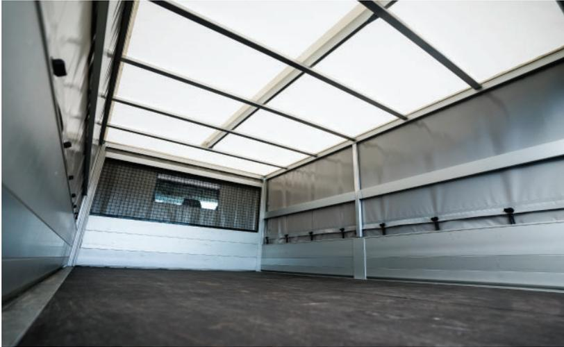
Armaton MP Tarpaulin\* possède un toit translucide offrant suffisamment de lumière sur la zone de chargement. Le hublot fixé au tablier permet une vue d'ensemble depuis la cabine.
