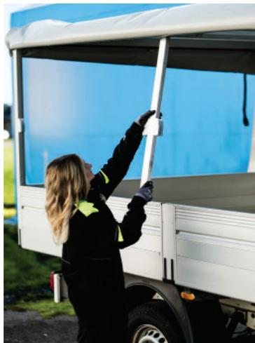
Pour les plateaux avec un rancher latéral, le système peut être équipé de barres latérales amovibles afin de faciliter le chargement et le déchargement.
