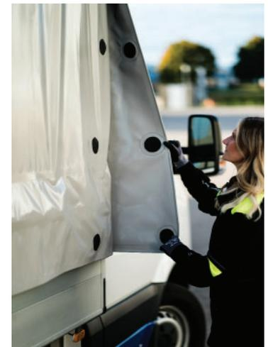
La bâche est facile à fermer avec des sangles fixées à l'intérieur et un verrouillage magnétique.
