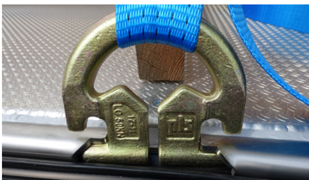
Exempel på löstagbara surrningspunkt som har LC 50 kN (5 ton) respektive 16 000 daN (16 ton).
