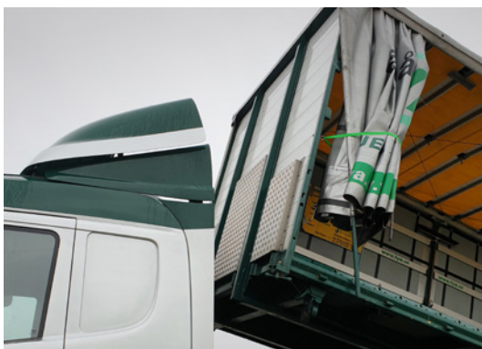
Typiskt slagprovad framstamskonstruktion.
