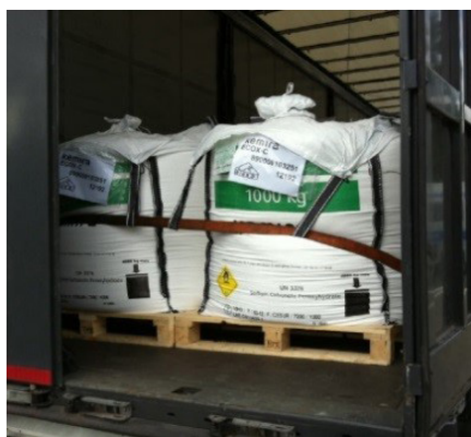
Exempel på gramma som hindrar säckarna att röra sig bakåt.
