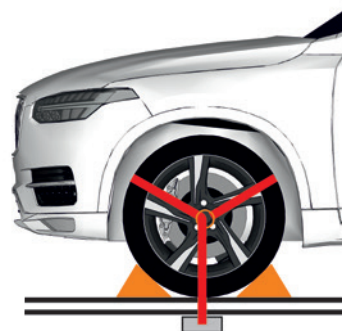
Metod 1 - Surrning som är dragen som ett sling runt hjulet i kombination med klossar.
