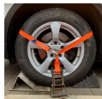
Exempel på surrning som är dragen som ett sling runt hjulet.
