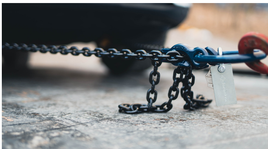
Bärgarkätting 2-Part Hajkrok Art.nr: 242010026 8mm Kätting | Längd: 2,0 m WLL: 2,0ton | LC: 56 kN Förkortningskrokar
