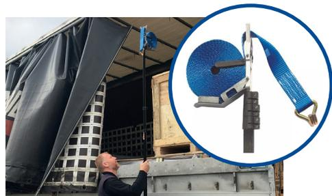
2) **Fonction STRAP-GO** : tout en assurant la **sécurité** du chauffeur, la sangle est déroulée pour couvrir le chargement depuis le sol, et ce jusqu'à 4m max. Il limite ainsi le risque de troubles musculosquelettique (TMS).
