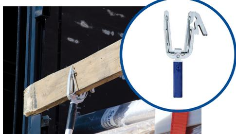
1) **Fonction SECU-STICK** : le chauffeur pose et dépose les ridelles en hauteur jusqu'à 3m50, **sans effort** tout en restant au sol. Il peut également mettre en place des coins et cornières de protections (longueur max 1m20).
