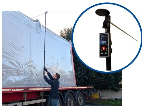
5) **Fonction MEASURING-STICK** : permet de mesurer la hauteur d'un véhicule ou d'une charge depuis le sol. Le laser du télémètre prend repère au sol jusqu'en haut de la cible noir. Egalement détachable, il peut mesurer jusqu'à 100m. Les mesures s'affichent sur l'écran.
