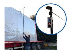
5) **Fonction MEASURING-STICK**: permet de mesurer la hauteur d'un véhicule ou d'une charge depuis le sol. Le laser du télémètre prend repère au sol jusqu'en haut de la cible noir. Les mesures s'affichent sur l'écran.
