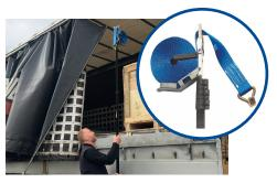
2) **Fonction STRAP-GO**: tout en assurant la **sécurité** du chauffeur, la sangle est lancée pour couvrir le chargement depuis le sol, et ce jusqu'à 4 mètre maximum. Il limite ainsi le risque de troubles musculosquelettique (TMS).
