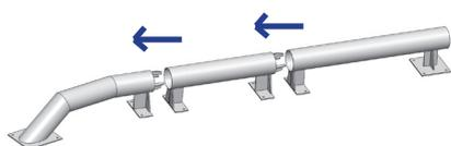
**Etape 2 (OPTION).** Assembler la partie arrière (B) à l'option extension (D) puis l'option extension (D) à la partie avant (A).
