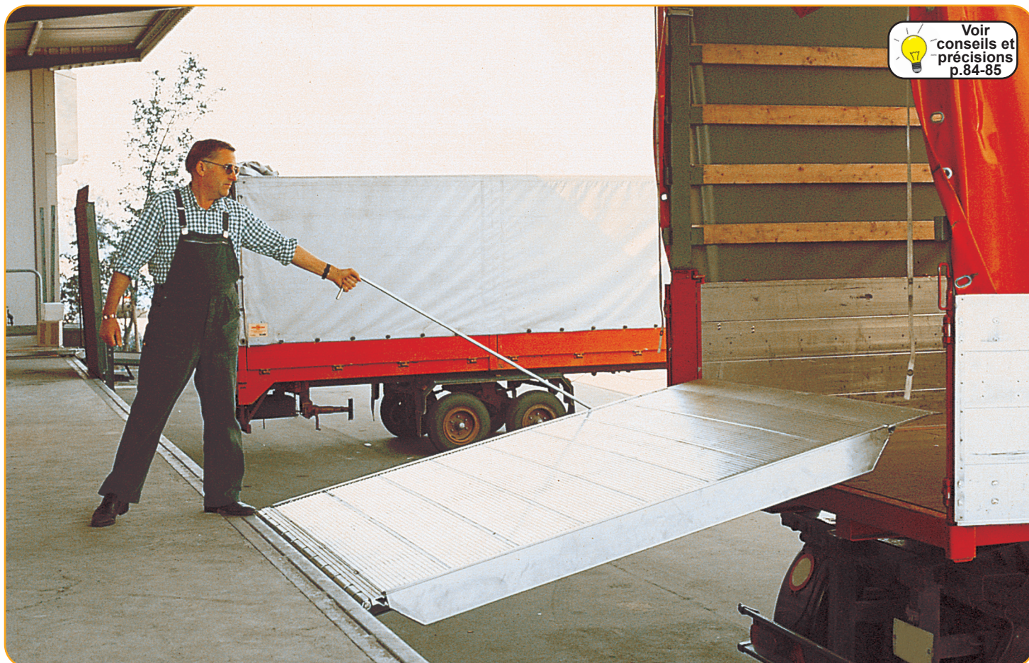
Lèvre segmentée permet de rattraper maxi 40 mm de dévers
