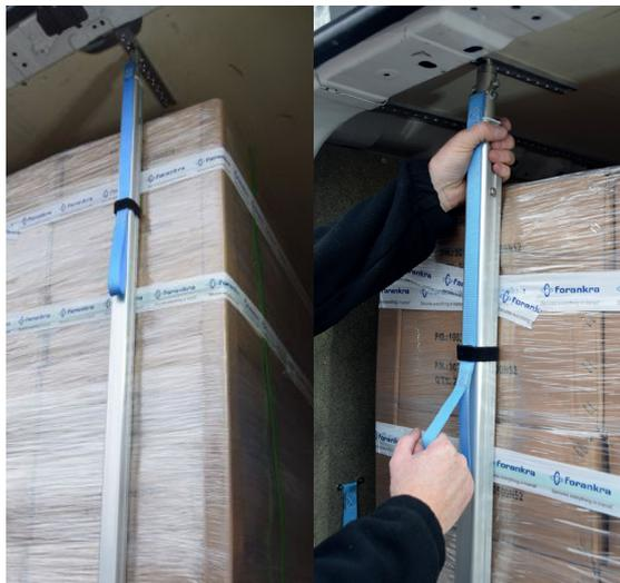
La SMARTBAR est une barre de blocage adaptée aux véhicules type utilitaire, léger et petit porteur. (Modèles H1 et tous types de H2).
