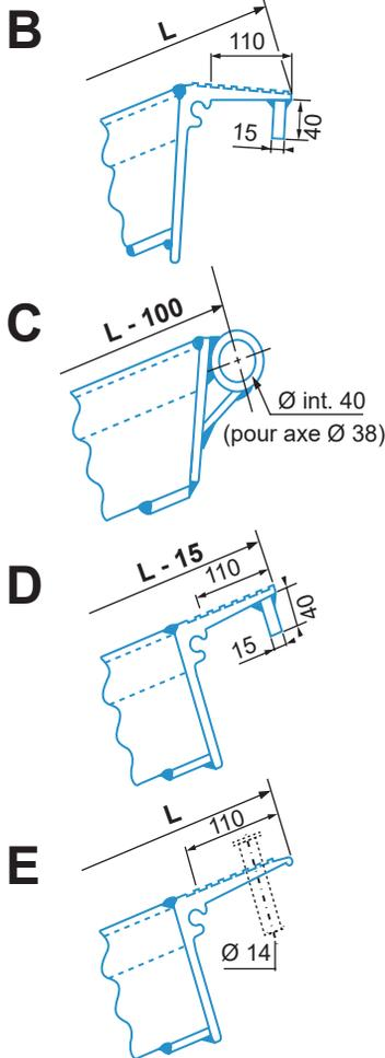
NB : Suivant le type d'accrochage, la longueur et la capacité des rampes peuvent varier.
