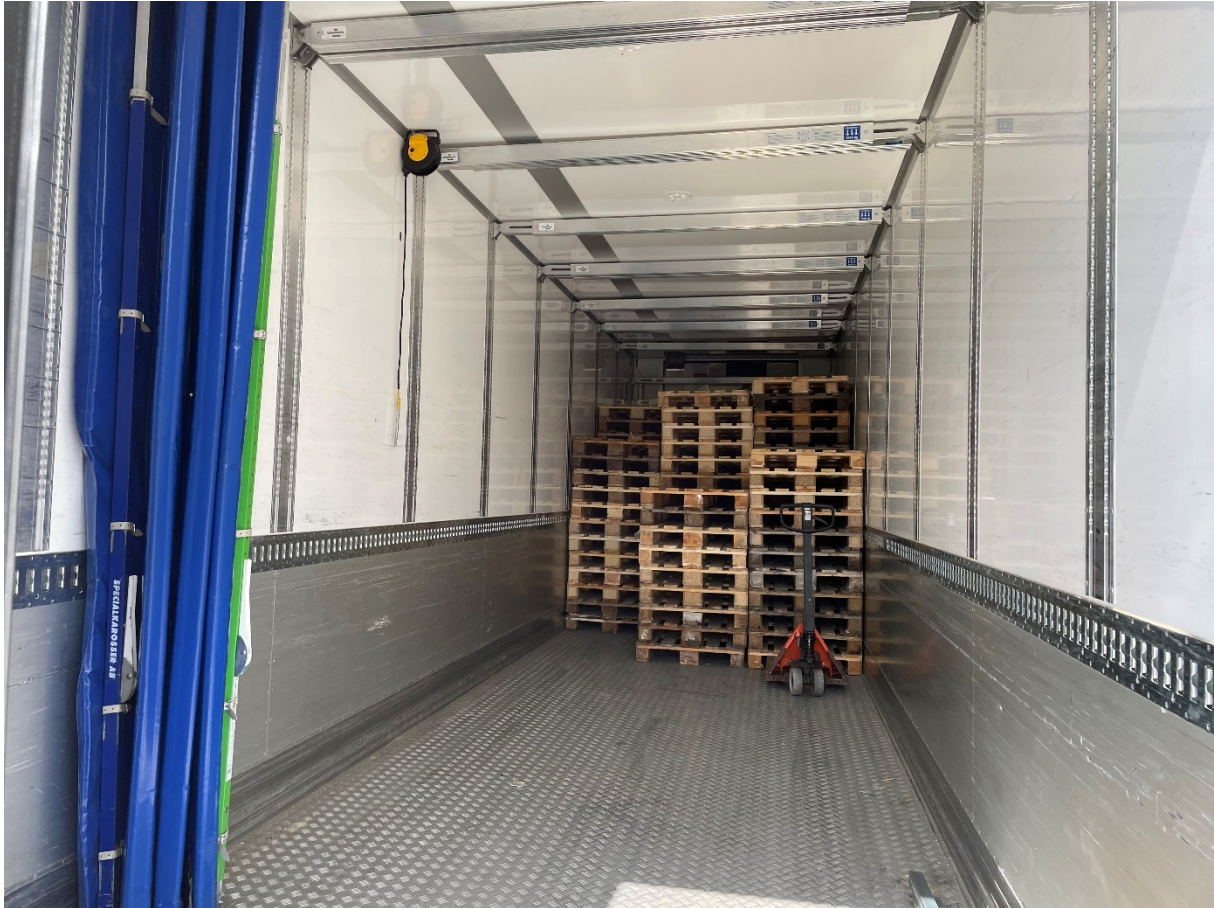
Dubbla lastplanssystem modell vägg-vägg. Bommarna skjuts upp högst upp i skenorna när de ej används, lastbäraren har ej öppningsbar sida.
