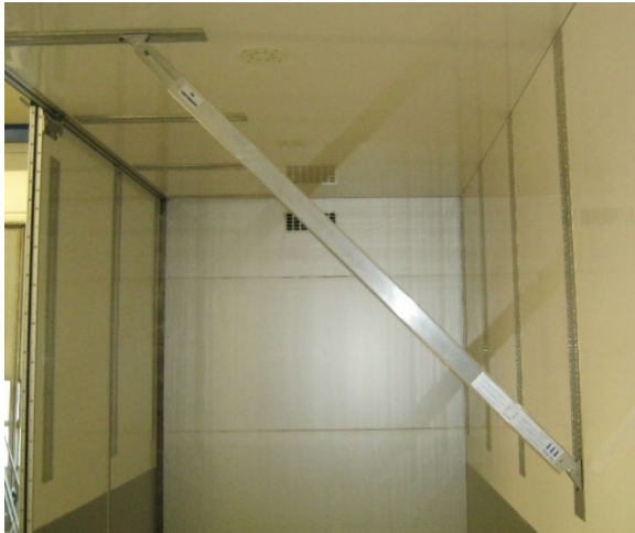
Dubbla lastplanssystem modell takhängning för lastbärare med öppningsbar sida. Bommen toges ur väggskenan, förs in i takskenan och sedan även i väggskenan på den fasta sidan, där sedan bommen förs hela vägen upp mot taket.
