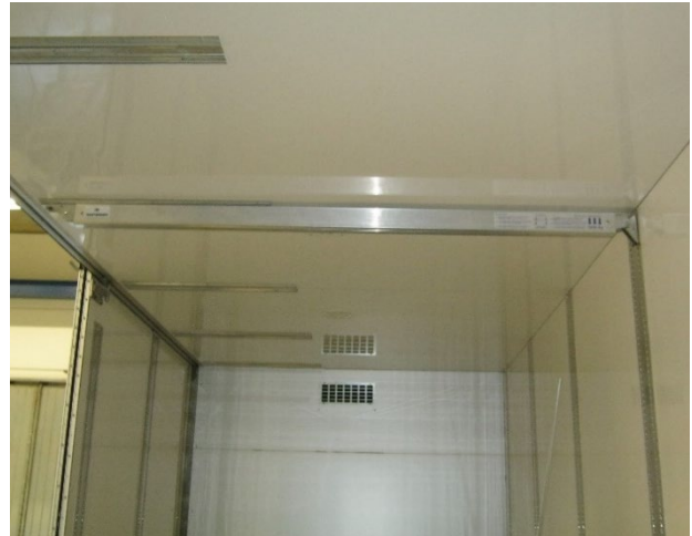
Dubbla lastplanssystem modell takhängning för lastbärare med öppningsbar sida. Bommen toges ur väggskenan, förs in i takskenan och sedan även i väggskenan på den fasta sidan, där sedan bommen förs hela vägen upp mot taket.
