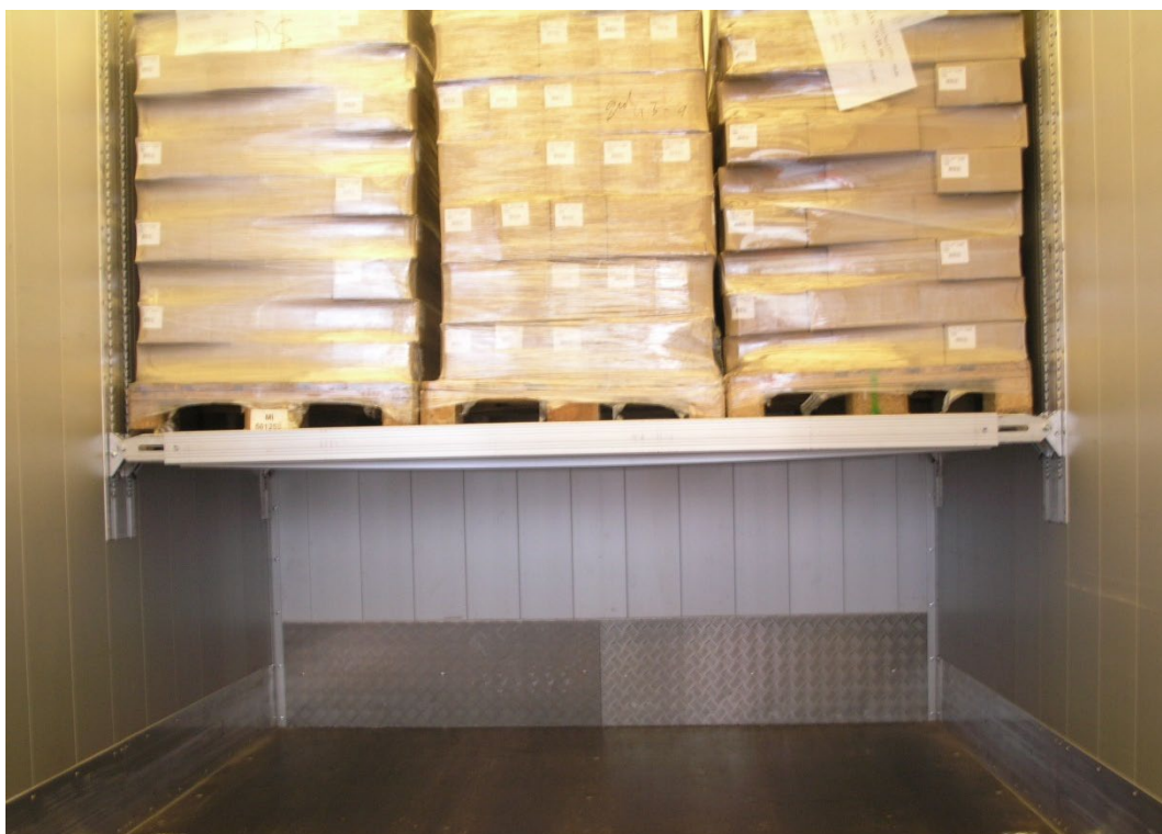
Belastad bom som sviktar, det är OK (Bommen framför är obelastad och används som referens)
