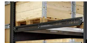
Pour une utilisation optimale du système CTD-3, nous recommandons une distance entre poteaux de 2,42m. Ainsi vous pouvez positionner 6 palettes EURO (2 rangées de 3 palettes dans le sens des 1200mm) dans cet intervalle.
