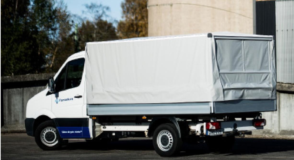
Das Armaton MP Tarpaulin Kit enthält eine Plane mit Aluminiumgestell, das für die AMP entwickelt wurde. Der Bausatz ist einfach zu montieren und demontieren, da das Gestell in die vorhandenen Rungen auf der Plattform montiert wird und die Plane direkt an der Bordwand befestigt wird, ohne dass äußere Riemen oder Gurte erforderlich sind. Die seitlichen Planen und das Dach sind separat um die Montage zu erleichtern. Das Dach ist lichtdurchlässig.
